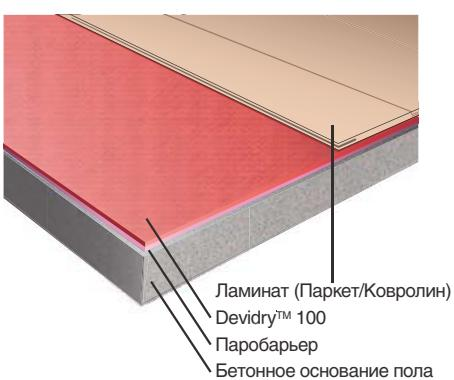
В Россию поставляются нагревательные маты с удельной мощностью 100 Вт/м<sup>2</sup> при 230 В, что согласно Европейским норм запрещает их установку на деревянное основание пола (пол под матом). То есть основание пола должно быть бетонным, цементно-песчаная стяжка или подобное.
