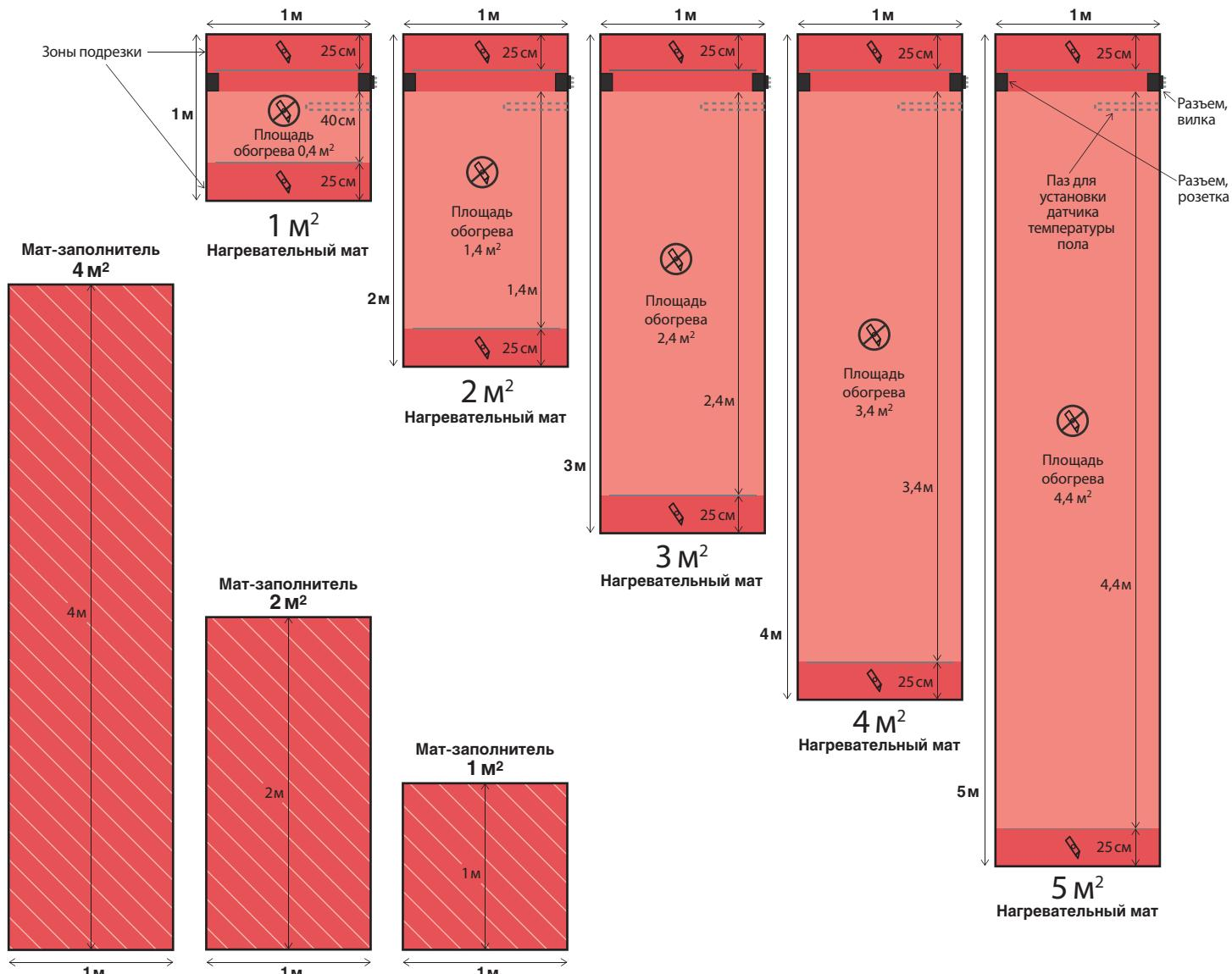
Если остались свободные участки пола, то на них устанавливается мат-заполнитель Devidry™ FM, выпускается площадью 1, 2 и 4 м<sup>2</sup>, или остатки матов с зонами подрезки.
