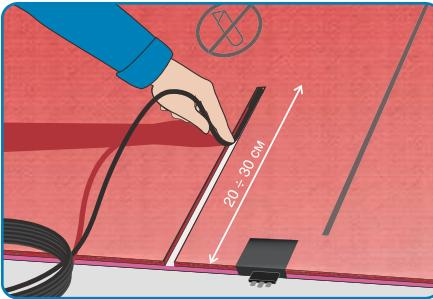
В полученной вырезе-канавке уложите датчик с проводом. Датчик (утолщение на конце кабеля) не должен касаться нагревательных кабелей и располагается между ними. Вырез сверху проклеивается алюминиевым скотчем из набора **Devidry™ Kit**.
